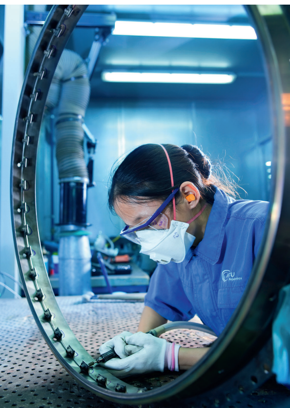
4 Manuelle Arbeitsschritte, wie in diesem Fall das Biax-Schleifen, sind im Rahmen der MRO-Tätigkeiten nicht wegzudenken
