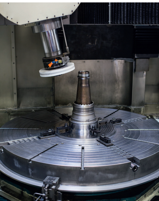
6 Rundschleifvorgang im Rahmen der Triebwerksreparatur: Hochanspruchsvolle Werkstoffe sind im Rahmen von auditierten Prozessen zu bearbeiten © MTU Aero Engines
