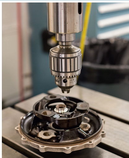
7 Präzises Bohren und Gewinden: Die Bearbeitungsgenauigkeit der einzelnen Komponenten genügt bei einem Triebwerk generell hohen Ansprüchen © MTU Aero Engines
